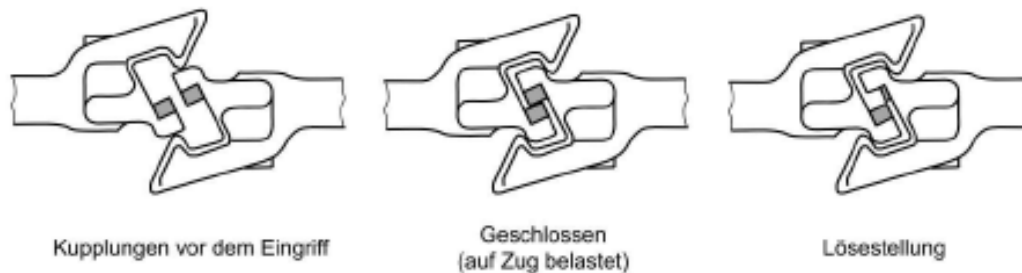
Abbildung 13: Wirkungsweise der Willison-Kupplung
